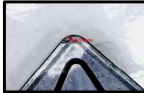
Gambar 3.9 Contoh pengukuran aus pahat
