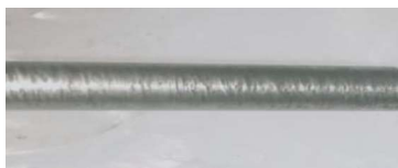
Gambar 3.7 Baja material VCN (AISI 4340)
