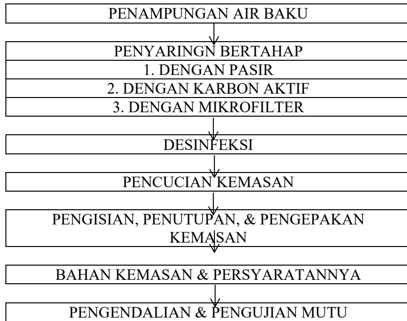
Gambar 2. 1 Diagram Alir Proses Produksi Air Minum Dalam Kemasan (AMDK)
