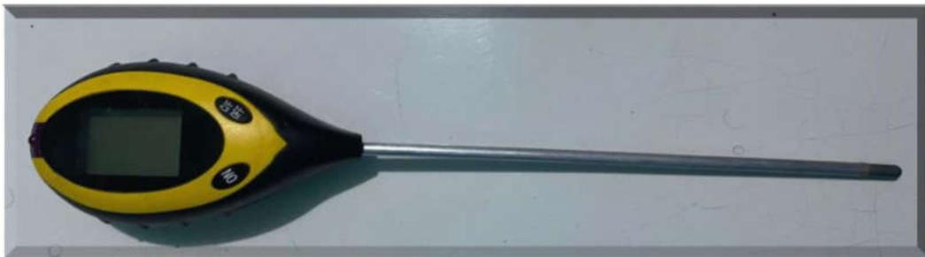
**Gambar 2.2** Alat ukur pH tanah
