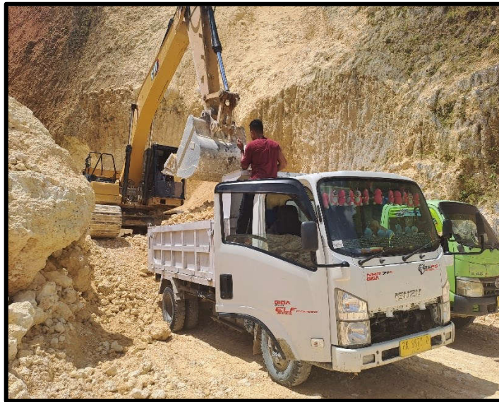
Gambar 2. 2 Alat Angkut Dump Truck ( Dokumentasi Lapangan Adindha )
