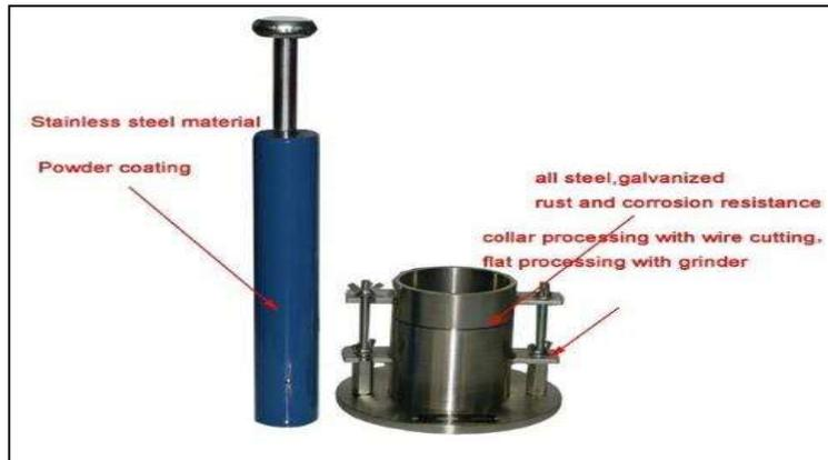
Gambar 2. 3 Pengujian Pematatan Proctor Standart
