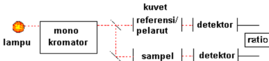
Gambar 2.4 Skema Alat Spektrofotometer UV-Vis Double-beam
