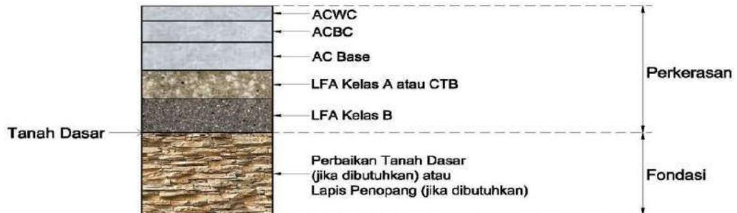
Gambar 2.6 Perkerasan Lentur pada Permukaan Tanah Asli
