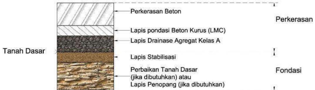
Gambar 2.9 Perkerasan Kaku pada Permukaan Tanah Asli
