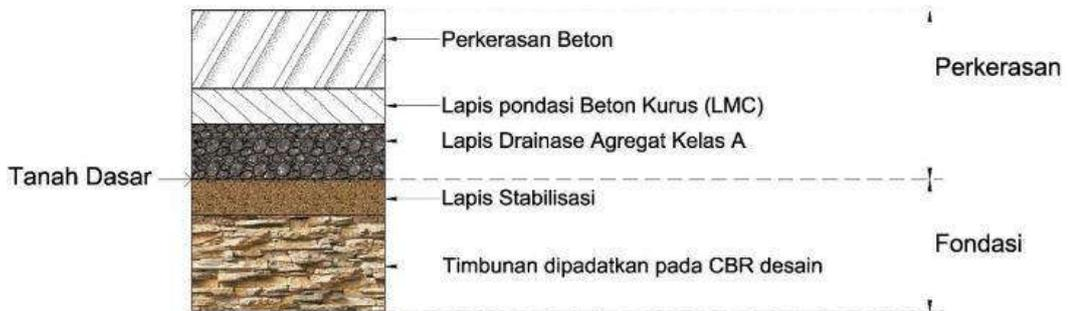
Gambar 2.10 Perkerasan Kaku pada Timbunan
