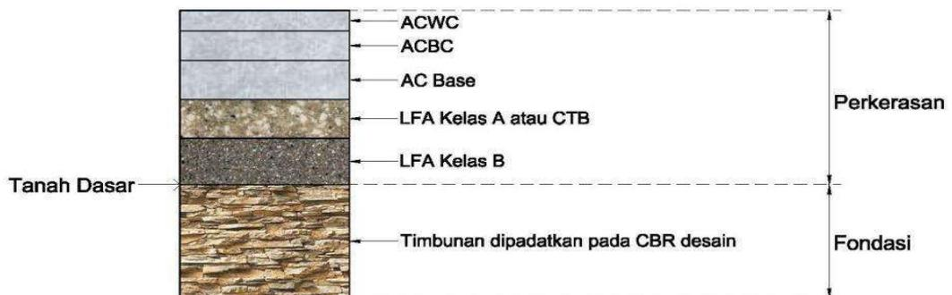
Gambar 2.7 Perkerasan Lentur pada Timbunan
