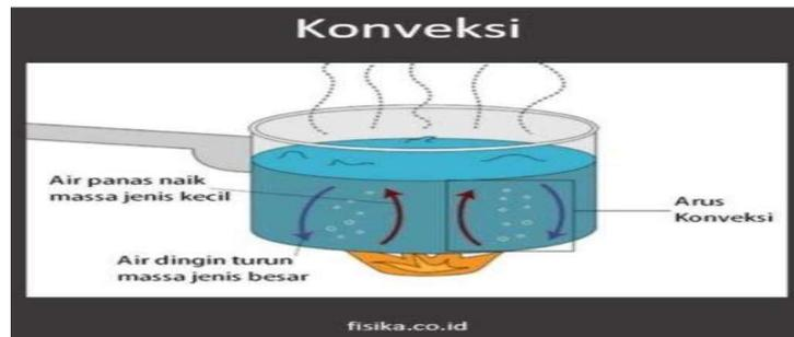
**Gambar 2.3**Perpindahan panas secara konveksi
