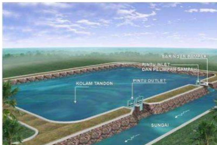
Gambar 2.10 Kolam Retensi Tipe di Samping Badan Sungai
