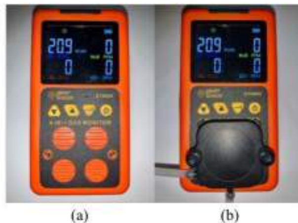
Gambar 2.3 Alat Smart Sensor 4-in-1 Gas Monitor ST8900 (a) sebelum menggunakan sampling pump , (b) setelah menggunakan sampling pump .
